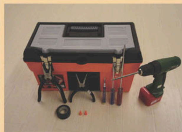
灯具安装所需工具：虎钳、尖嘴钳、电笔、一字螺丝刀、十字螺丝刀、电工胶布、接线端子等。
